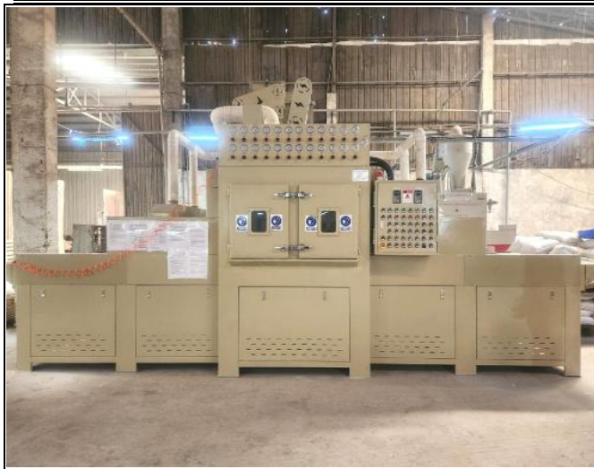
Xử lý bề mặt bằng máy phun cát dạng băng tải tự động và thiết bị lọc bụi đi kèm
