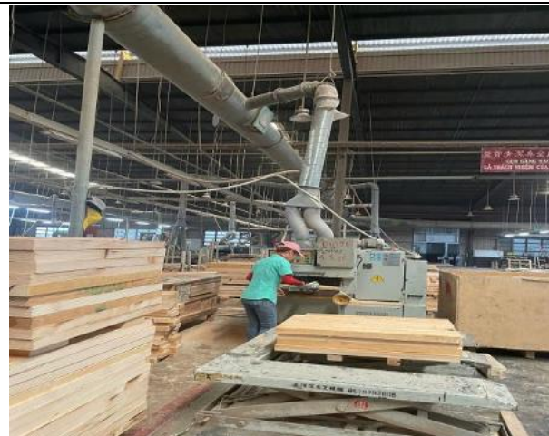
Hệ thống chụp hút, đường ống thu gom bụi về hệ thống xử lý
