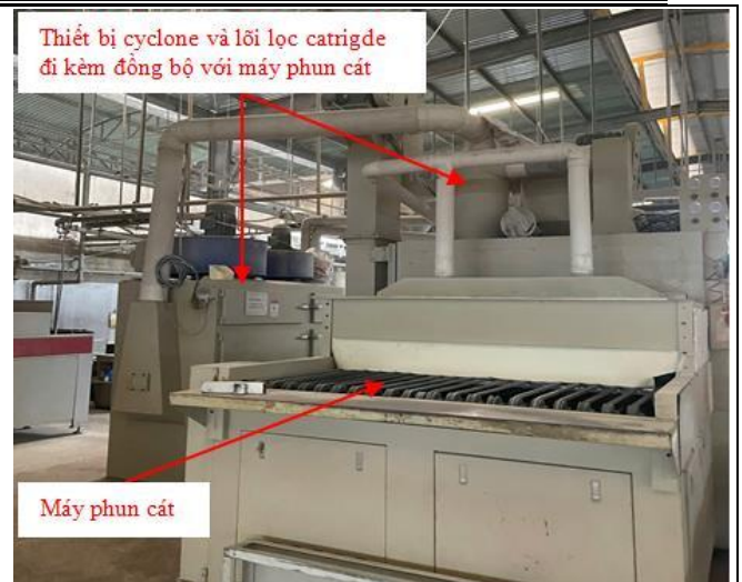
Xử lý bề mặt bằng máy phun cát dạng băng tải tự động và thiết bị lọc bụi đi kèm
